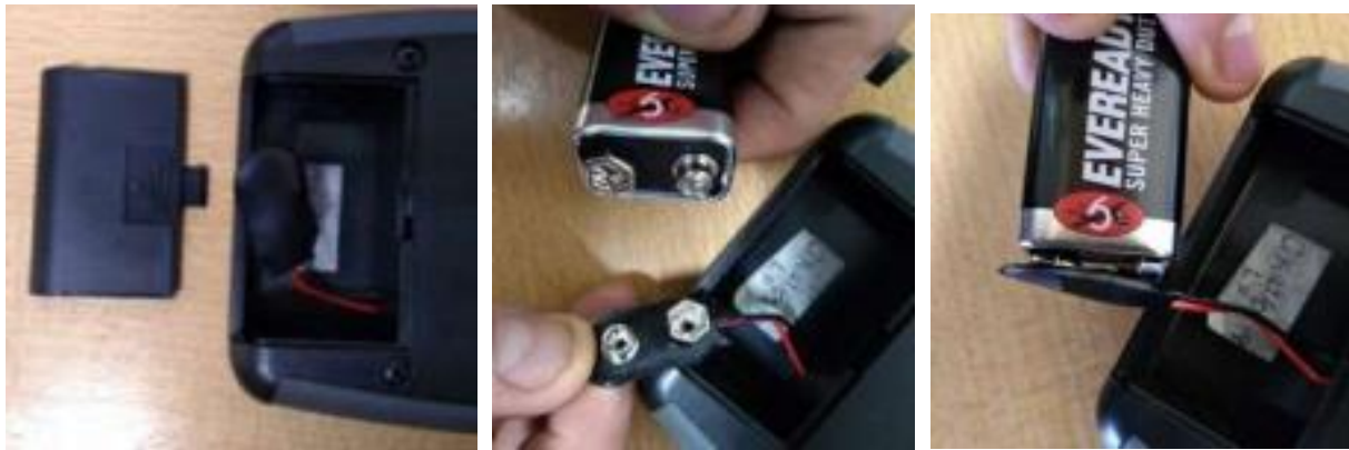
Figure 3 : À gauche : couvercle coulissant et compartiment à piles; au centre : positionnement de la pile par rapport au connecteur; à droite: Connexion de la pile
